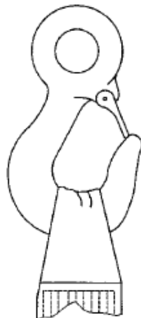
Afbeelding A — Weergave van een onjuiste aanpassing van een lusband aan een haak met een te kleine radius
