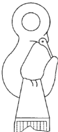
Figura A: Representación de un ajuste inadecuado de una correa de lazo a un gancho con un radio demasiado pequeño
