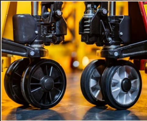
Links Polyurethan-Bereifung, rechts Vollgummi-Bereifung mit Alu-Felgen
