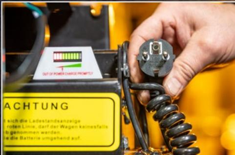
Laden des elektrischen Modells über 220-V-Stecker, das Ladegerät ist integriert
